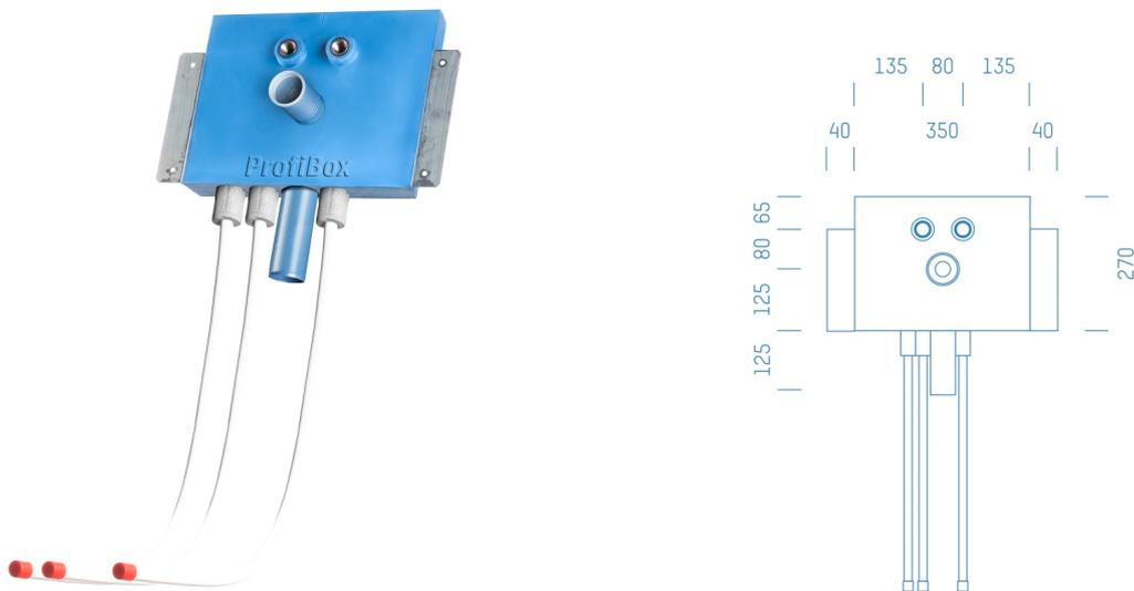
Sanitärmodul f. Waschtisch Zirkulation nur Warmwasser, Boxenstärke: 7cm, Trockenbau, DN18, Geberit Mapress Edelstahl, Rohrführung von oben, Abfluss: Polokal NG
