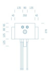
Sanitärmodul f. Waschtisch Zirkulation nur Warmwasser, Boxenstärke: 7cm, Trockenbau, DN18, Geberit Mapress Edelstahl, Rohrführung von unten, Abfluss: Geberit geschweißt
