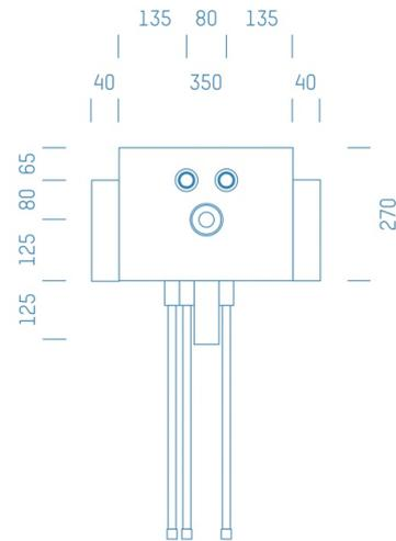
Sanitärmodul f. Waschtisch Zirkulation nur Warmwasser, Boxenstärke: 7cm, Trockenbau, DN18, Geberit Mapress Edelstahl, Rohrführung von unten, Abfluss: Rehau Raupiano
